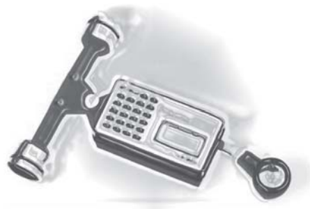
図 1 図面上の面積を図るために使用するプランメーター
