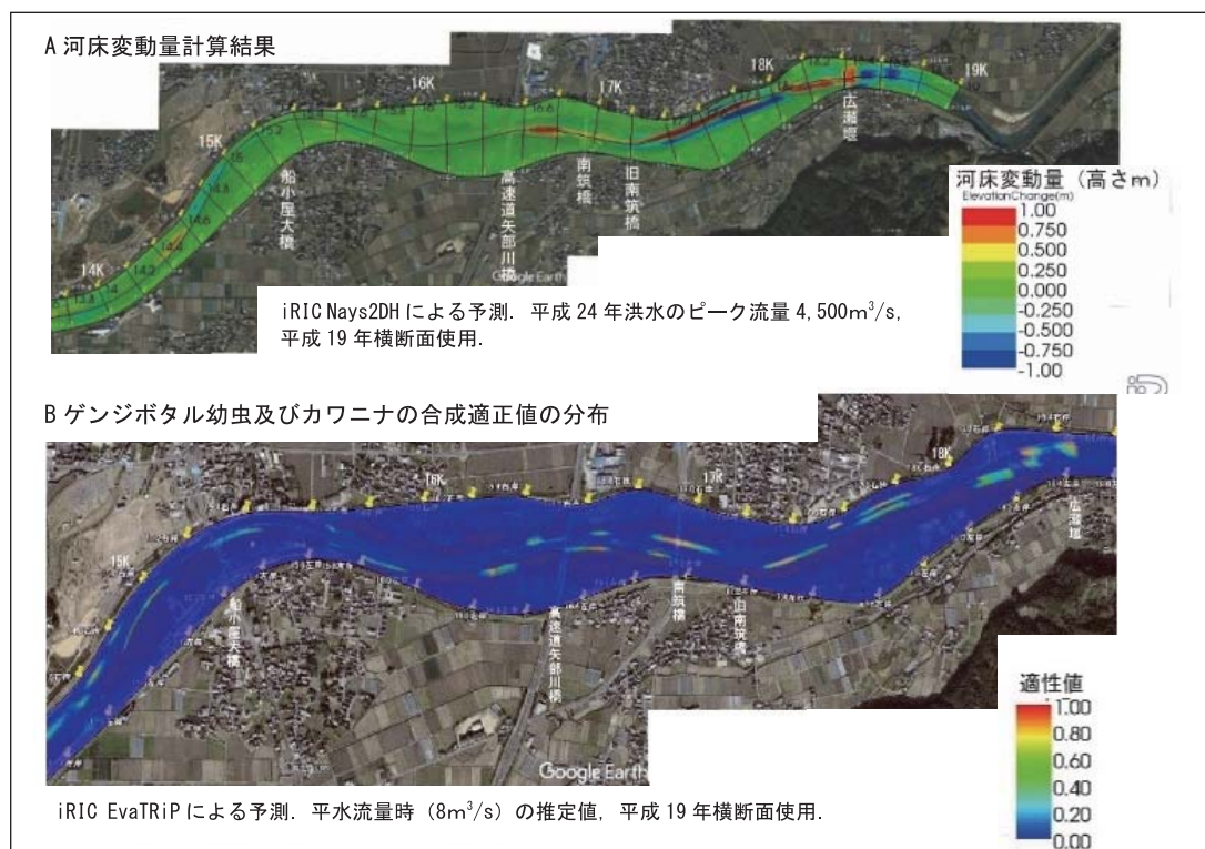
図 2 矢部川における河床変動計算結果、ゲンジボタル幼虫及びカワニナの合成適正値の分布 8)
