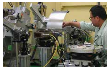
シンクロトロン光の利用 佐賀県立九州シンクロトロン光研究センター(SAGA-LS)のBL15ハッチ内でのX線回折分析。
